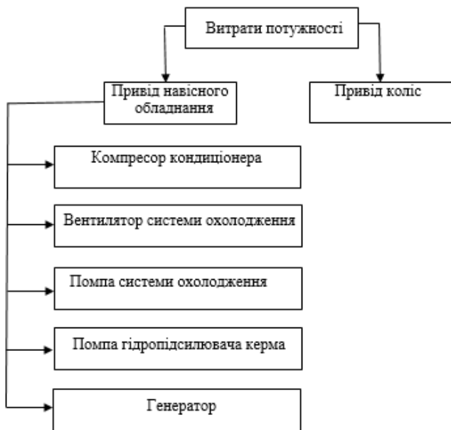
Рис. 1. Навісні споживачі потужності ДВЗ автомобіля
